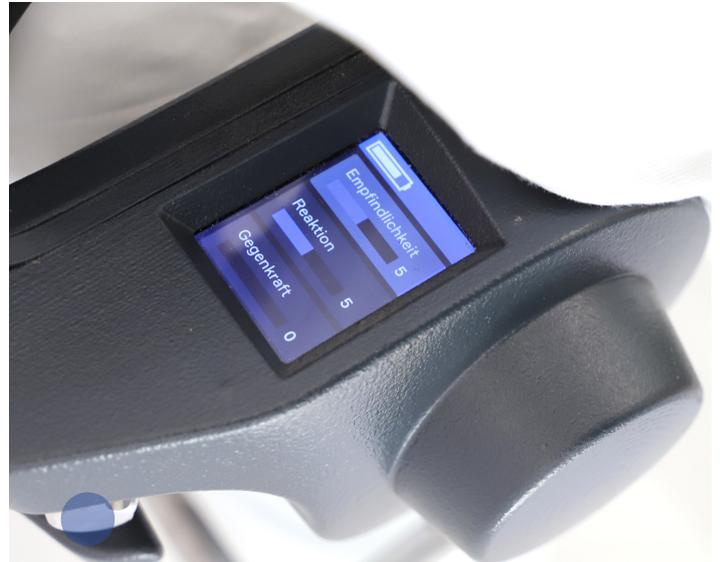
Wenn man den silbernen **Druck-Drehknopf** ca. 4 Sekunden lang drückt, kann man zwischen dem Modus statisch und Impuls wählen. Im Modus **statisch** kann (nur) die Unterstützung eingestellt werden. Der statische Modus eignet sich für statisches Arbeiten in gebeugter Haltung. Durch kurzes Drücken auf den **Ein-Aus-Knopf** gelangt man in den **Leerlauf**. Im Leerlauf findet keine Kraftunterstützung statt. Schnelle Bewegungen sind im Leerlauf nicht möglich.
