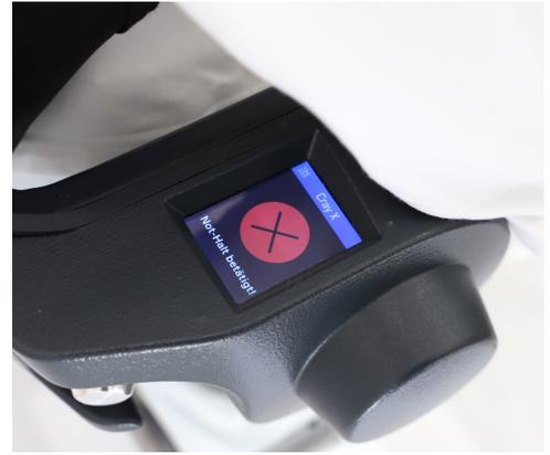
Der **Not-Aus Knopf** wird durch Drehen des silbernen **Druck-Drehknopfes** im Uhrzeigersinn gelöst. Das **Display** zeigt dann den Hinweis „Reset“. Der grüne **Ein-Aus-Knopf** wird betätigt und das System startet erneut mit dem Kalibrieren.
