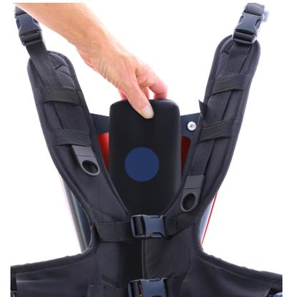
Im Anschluss werden alle Gurte gelockert und die Ratschen-Verschlüsse auf angenehm weite Position eingestellt. Es wird geprüft, dass die Verschlüsse am **Brustgurt** und am **Hüftgurt** sowie die Ratschenverschlüsse der **Beinanbindungen** geöffnet sind.
